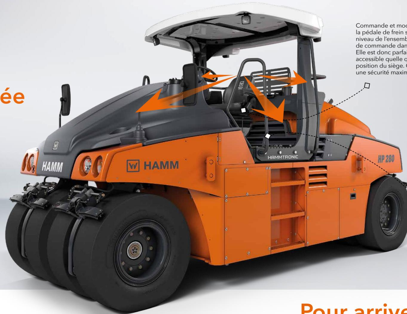
Commande et moderne et sûre : la pédale de frein se trouve au niveau de l'ensemble siège-unité de commande dans le HP. Elle est donc parfaitement accessible quelle que soit la position du siège. Cela garantit une sécurité maximale.
