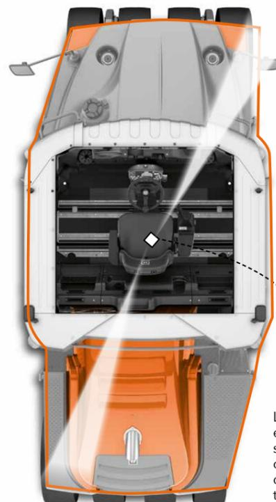
Lors du compactage, l'opérateur est assis à droite ou à gauche sur la plateforme et regarde de côté au-delà du capot moteur ou du réservoir d'eau. Ainsi, il voit toujours le chantier.
