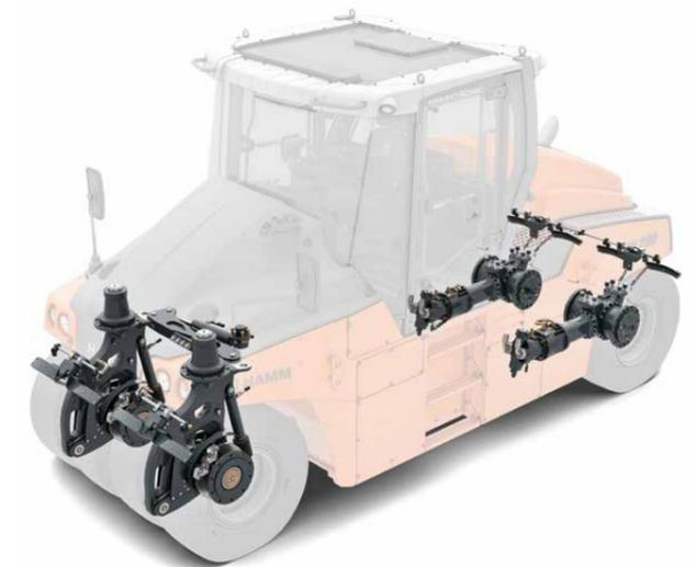
La force de freinage dont disposent les compacteurs à pneumatiques de la série HP peut, bien entendu, être dosée avec une très grande précision, car la commande de translation à assistance électronique permet de freiner et d'accélérer en douceur, ce qui est décisif pour obtenir de couches d'enrobé planes sans bourrelets ni effets de vague.
