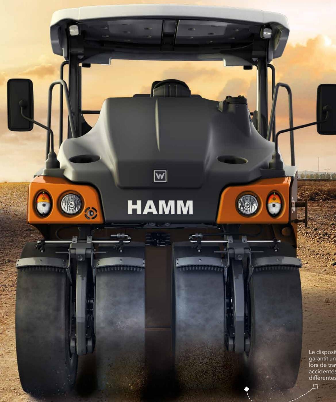
Le dispositif antipatinage garantit une motricité optimale lors de travaux sur terrains accidentés ou surfaces à différentes températures.
