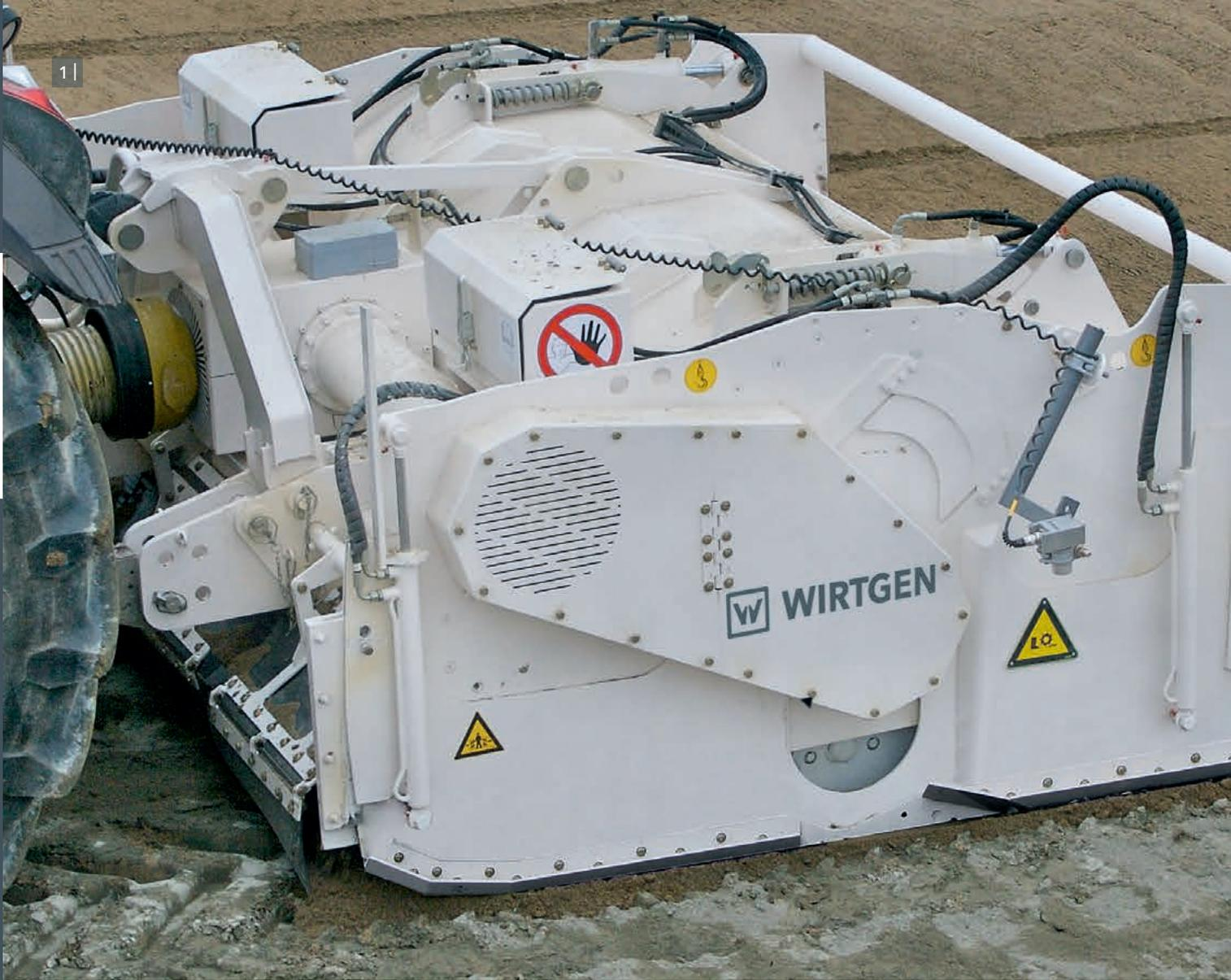
1 | Seul le rotor de fraisage et de malaxage pénètre dans le sol. La profondeur de fraisage momentanée peut être vérifiée sur l'affichage numérique de profondeur de fraisage.
