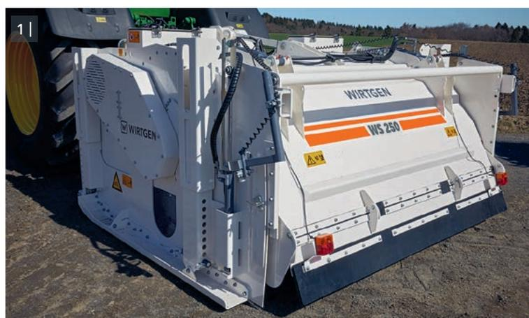
homogène du liant et du sol. La forme du carter du tambour de fraisage et l'abattant de tambour surélevé sont parfaitement adaptés au puissant rotor de fraisage et de malaxage. Placés sur l'abattant de tambour arrière, des vérins hydrauliques et des ressorts assurent une pression d'application optimale. De cette manière, la chambre de malaxage renferme toujours la quantité optimale de matériau et le stabilisateur rapporté laisse derrière lui une surface absolument plane.
