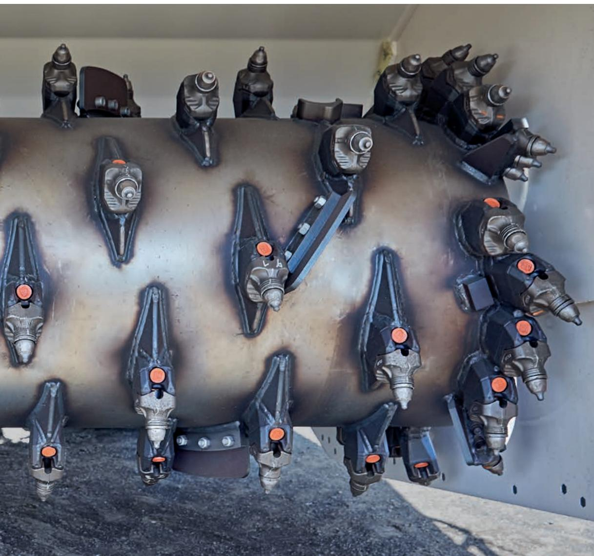
**2** | Le système à porte-pics interchangeable HT22 réduit nettement les coûts d'exploitation de la machine.
