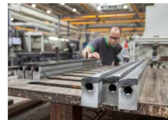
Profondeur de trempe homogène de 5 mm pour les dameurs et les lames de pression.
