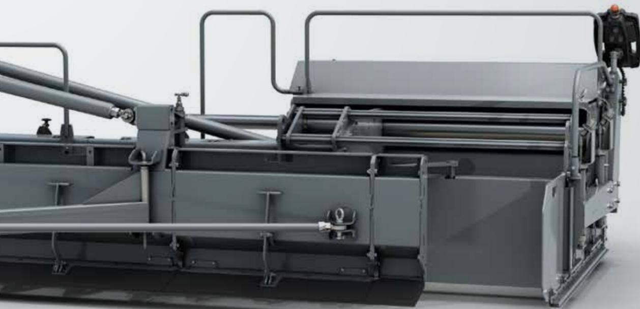
**Les tables fixes (SB)** sont particulièrement bien adaptées à la pose en grandes largeurs de travail. Les rallonges extensibles de VÖGELE permettent de faire varier la largeur de pose en continu jusqu'à 2,5 m. Ceci permet une économie de temps et d'argent car il rend superflu le montage et le démontage des rallonges lorsque la largeur de la chaussée varie jusqu'à 1,5 m sur le chantier.
