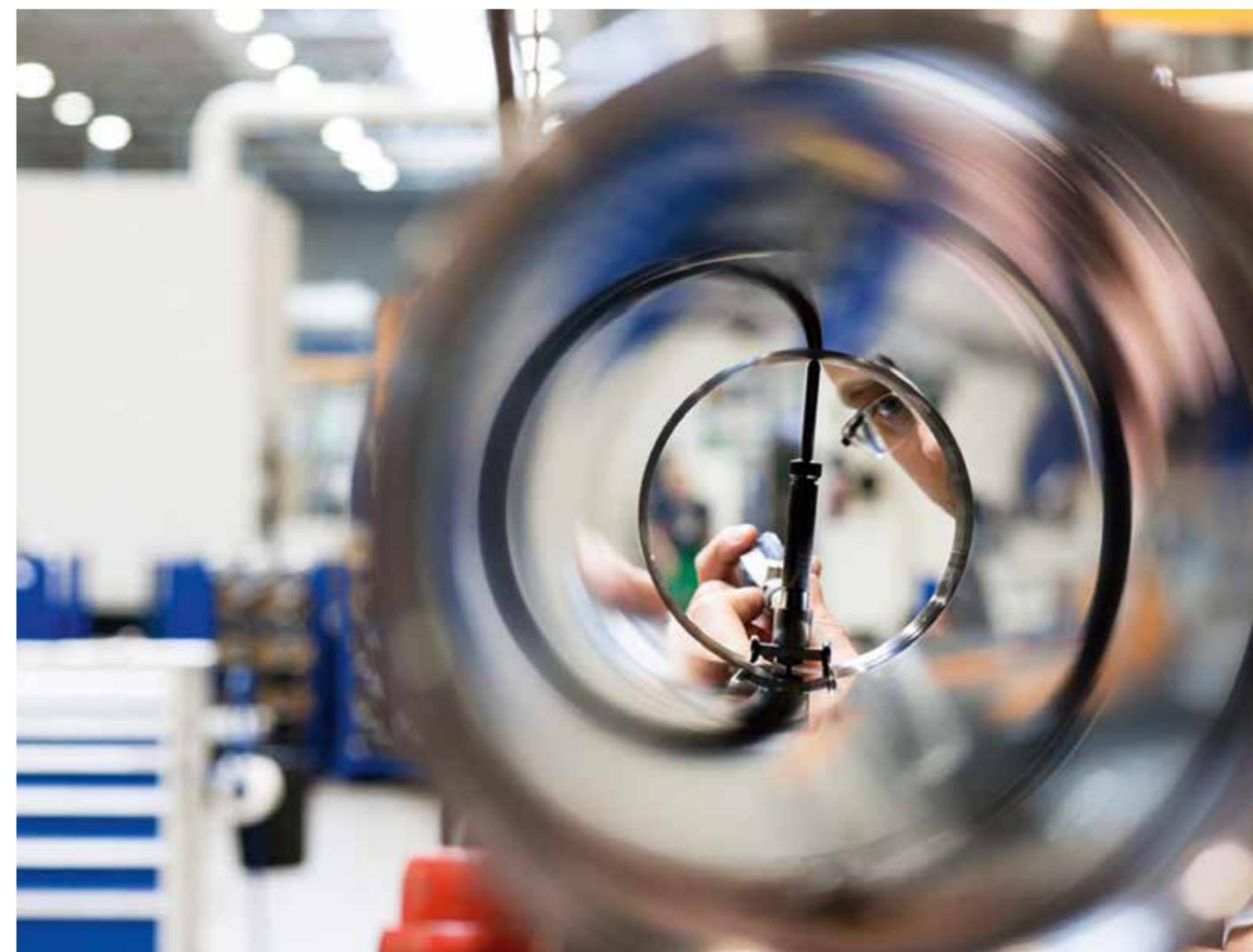
20 fois plus fin qu'un cheveu humain : la surface de glissement à l'intérieur des tubes de guidage est usinée avec la plus haute précision possible.
