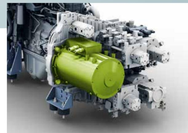
Des alternateurs puissants, souvent dotés d'un entraînement direct, fournissent au système de chauffe l'énergie électrique requise. Cela permet une chauffe rapide de la table de pose.
